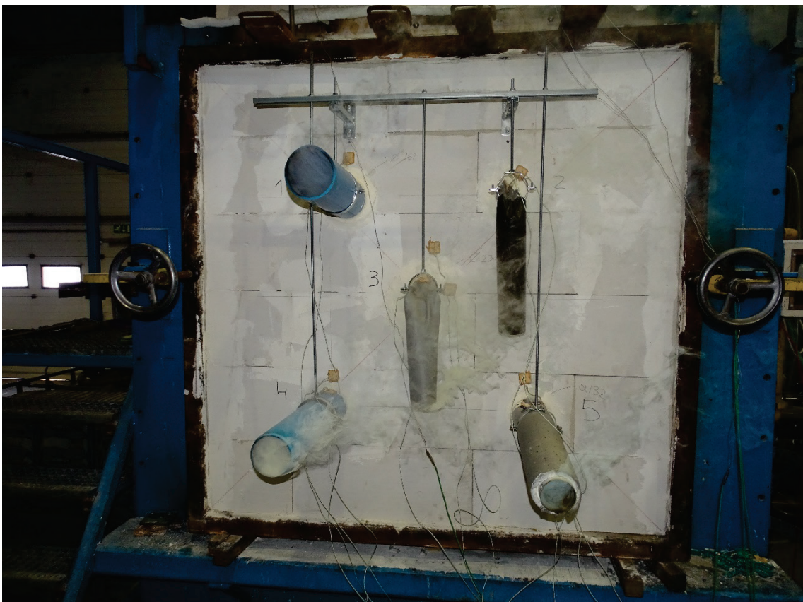
Foto 6 Proefstukken na 30 minuten verhitting
