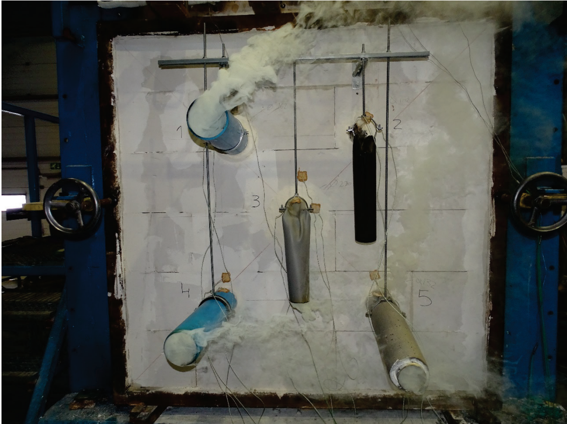
Foto 7 Proefstukken na 45 minuten verhitting
