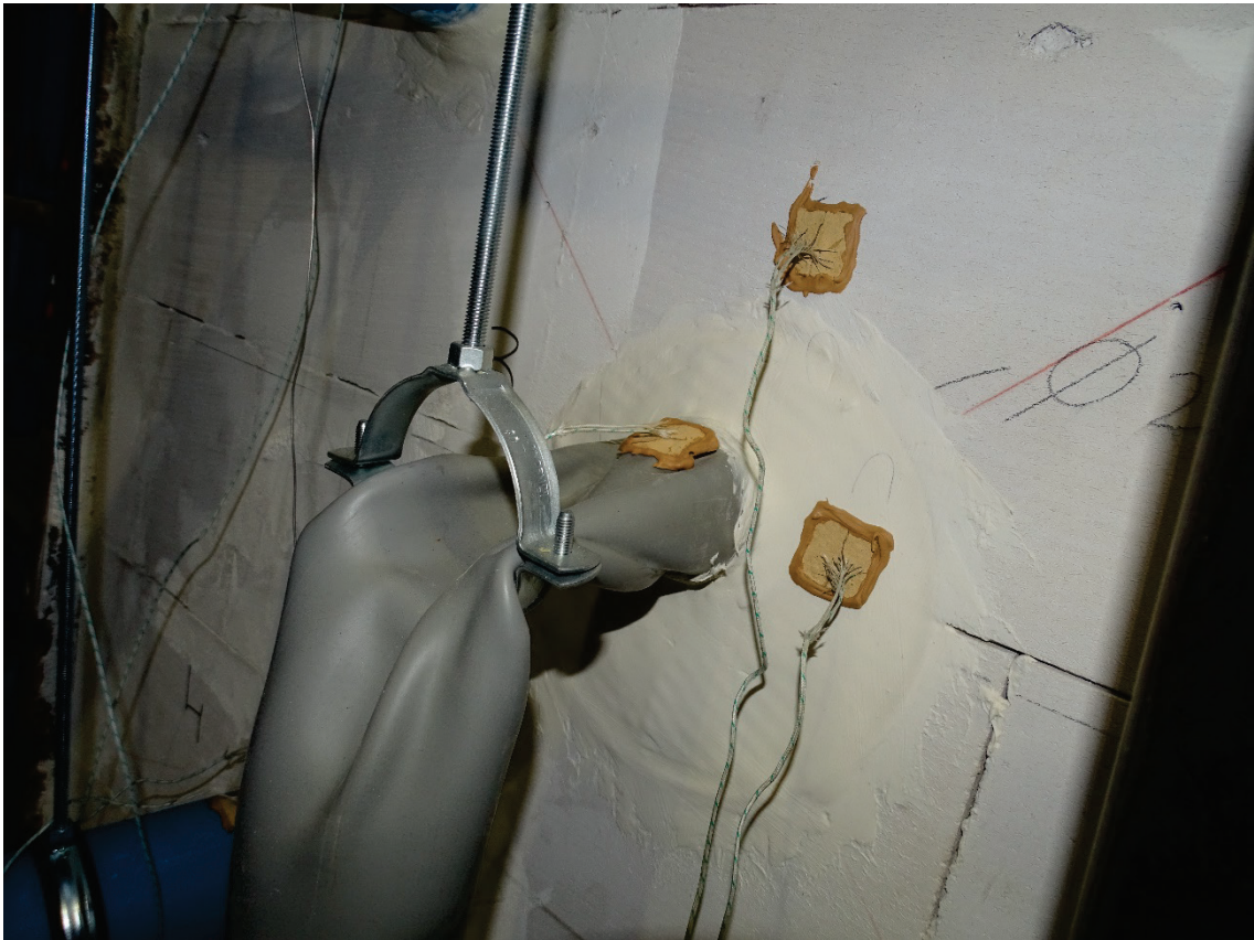
Foto 5 Proefstuk 3 na 16 minuten verhitting
